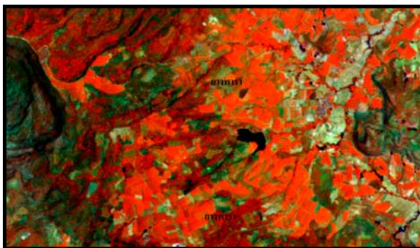
ภาพที่ 7 ภาพผสมสีเท็จจากดาวเทียมแลนด์แซท 5 ระบบทีเอ็ม (ช่วงคลื่น 4R - 5G - 3B) แสดงพื้นที่ปลูกยางพารา อำเภอนิคมน้ำอูน จังหวัดสกลนคร
