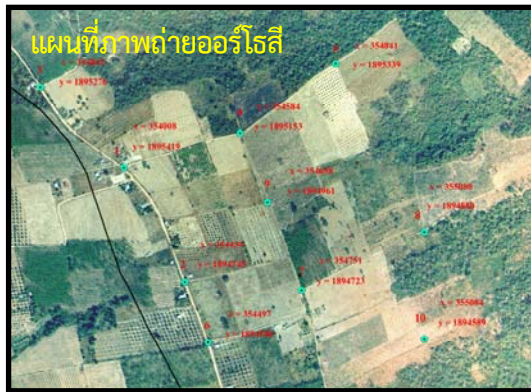
ภาพที่ 6 ภาพถ่ายทางอากาศออร์โธรี อ้างอิงค่าพิกัดในการแก้ไขความคลาดเคลื่อนทางเรขาคณิต
