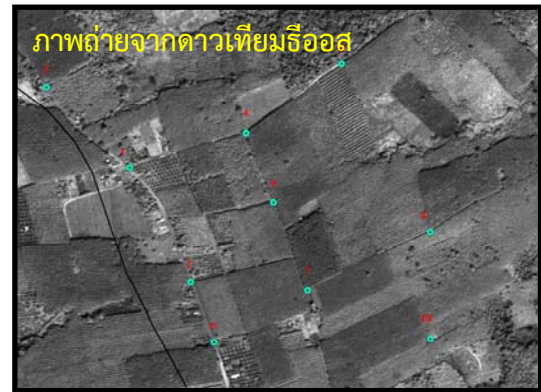
ภาพที่ 6 ภาพถ่ายทางอากาศออร์โธรี อ้างอิงค่าพิกัดในการแก้ไขความคลาดเคลื่อนทางเรขาคณิต
